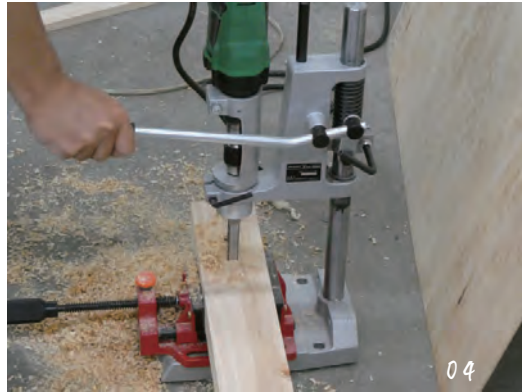
角のみで手すり子に穴を空けていく HIKOKI/ハイコーキ(日立電動工具) 変速ドリル D10VH2
