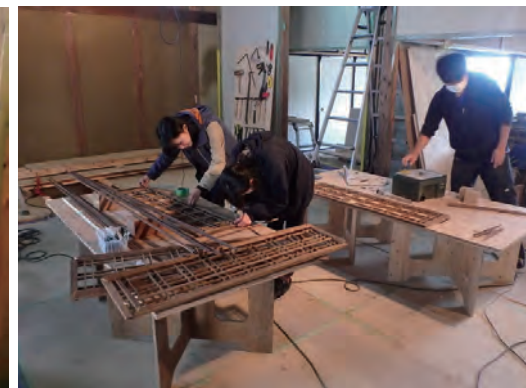
欄間の枠パーツを取り付ける
