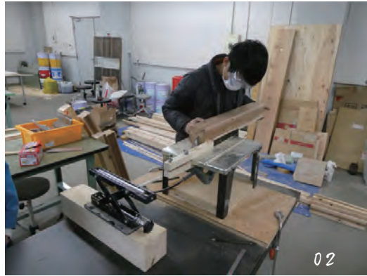
手すり子の幅にカットしていく
