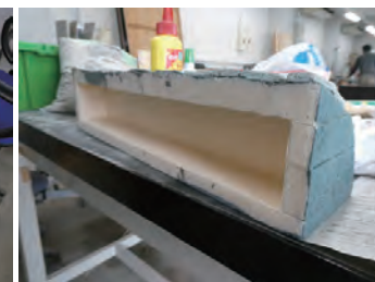
壁に固定する受け材が入る部分
