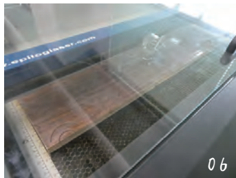
06 レーザー加工機を使用し、青海波を描く
